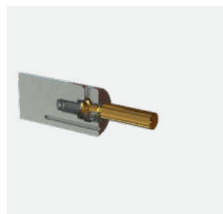
Querbohrung innen entgraten (Löffelentgraten)
