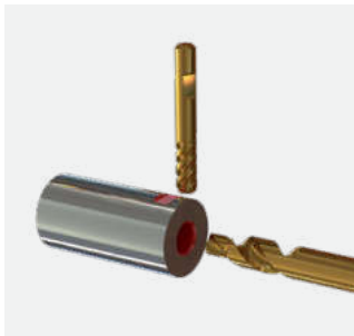
Bohren und fräsen simultan
